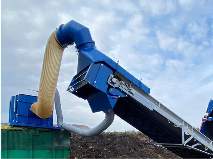
Bild 3: Ein AIRFIX Windsichter an einem Grobkornband
