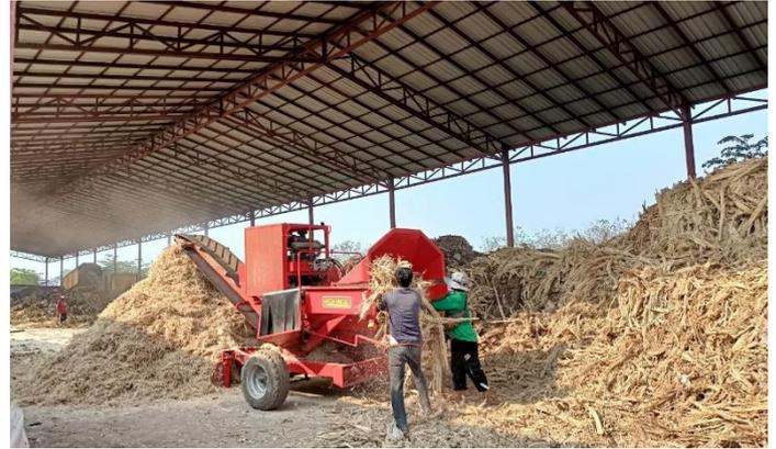
Bild 4: Shreddern von trockenen Bioabfällen
