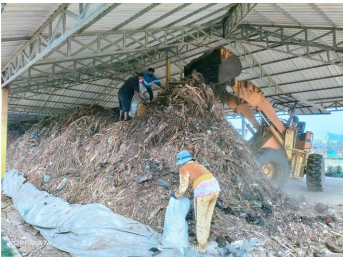
Bild 2: Manuelle Abtrennung von Störstoffen
