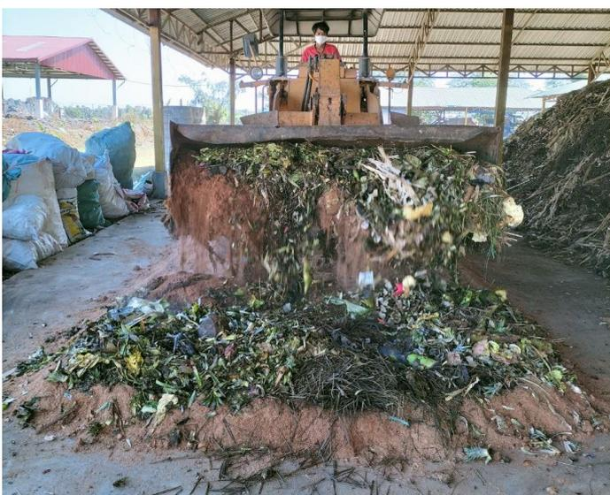
Bild 3: Aufsetzen der Mieten
